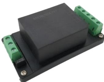
电源适配器安装在二次设备室，用于将二次设备室的低压交流/直流电源匹配至阅读器可用的 5V 直流电源。
