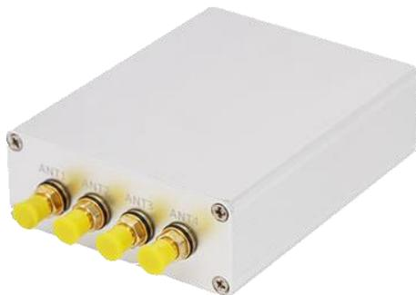
温度采集器安装在二次设备室，通过阅读器天线查询各个无线无源温度传感器的温度信息，并将采集得到的温度信息通过 RS485 总线传输至数据采集器或监控平台。
